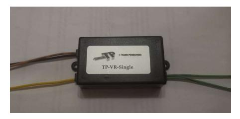
Der TP-VR-Single ist für eine Versorgungsspannung von 5V ausgelegt. (z.B. Sensorspannung vom Steuergerät)
